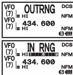
Sia che parliate o meno, l'interrogazione ogni 15 o 25 secondi continua finché disattivate l'ARTS™. Inoltre ogni 10 minuti la radio trasmetterà automaticamente in CW il vostro nominativo per identificare, come richiesto dai regolamenti, l'emissione radio. Quando si disattiva l'ARTS™ si disattivano anche i codici DCS (se non erano precedentemente all'avvio di ARTS™ già in uso per altra funzionalità).
